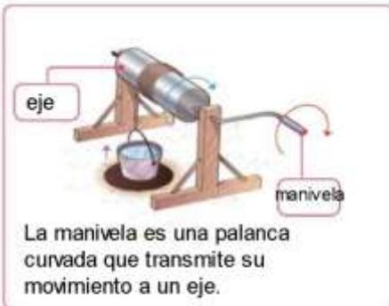
La manivela es una palanca curvada que transmite su movimiento a un eje.
